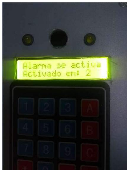
Figura 9. Conteo para activación de la alarma.
