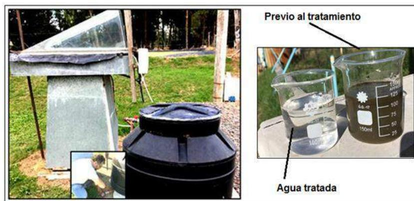
Figura 6. Tratamiento de aguas residuales con un destilador solar. UNRC. Río Cuarto. Córdoba.
