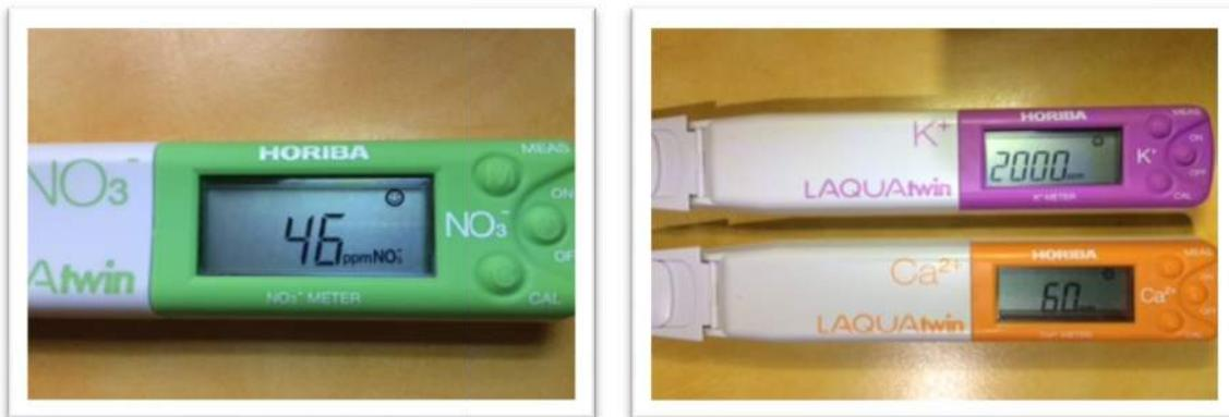
Fig. 3. Medidores de iones B-743 LAQUAtwin Compact Nitrate Ion Meter, B-731 LAQUAtwin Compact Potassium Ion Meter, B-751 LAQUAtwin Compact Calcium Ion Meter
