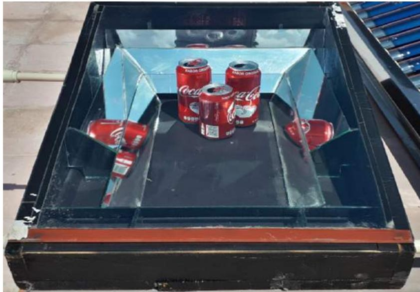
Figura.5. Prototipo elaborado con espejos para un mayor aprovechamiento de la radiación solar
