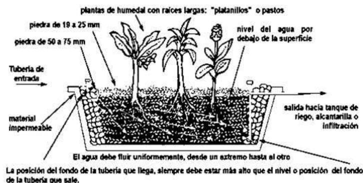
Figura 4. Esquema de filtración natural,
