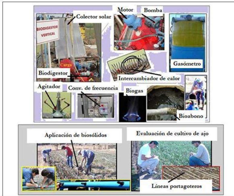
Figura 3. Sistema de biodigestión y aplicación de biosólidos. UNRC. Río Cuarto. Córdoba.
